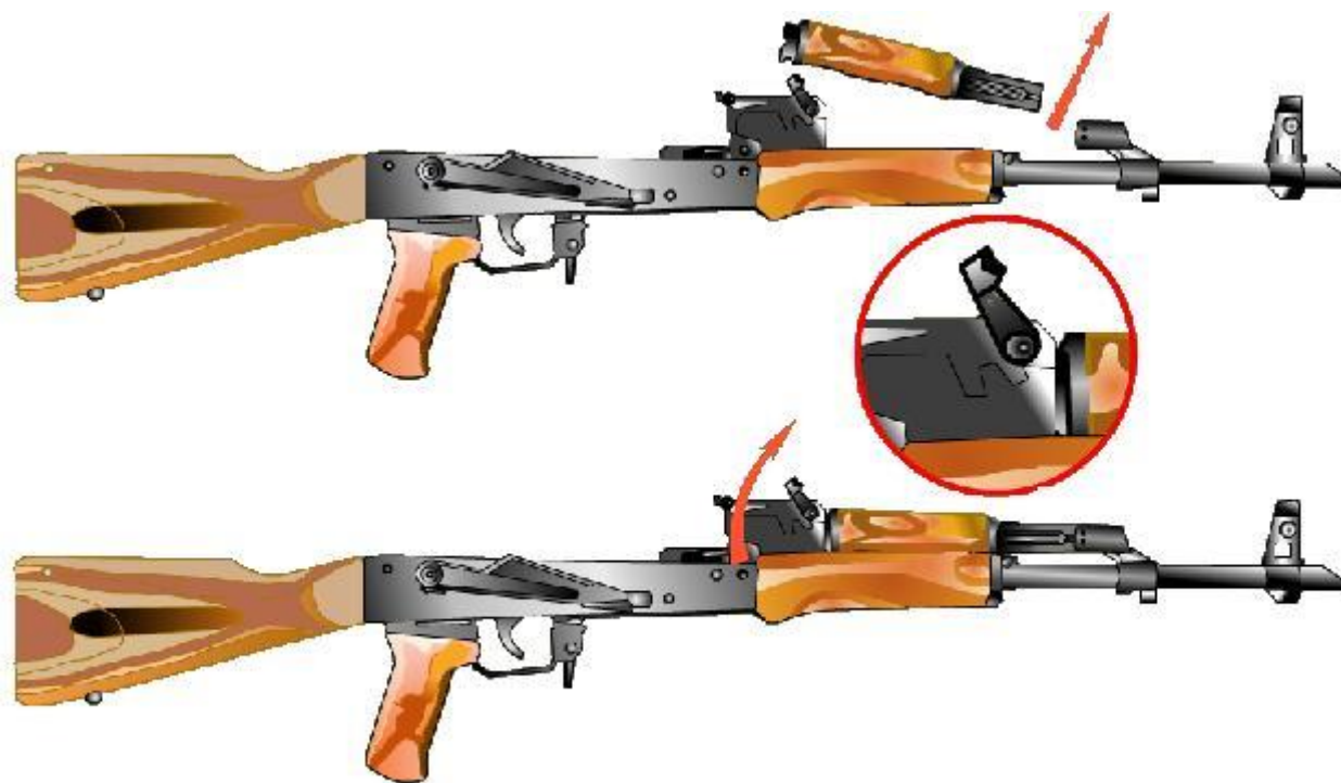
Рис. 9. Отделение газовой трубки со ствольной накладкой
