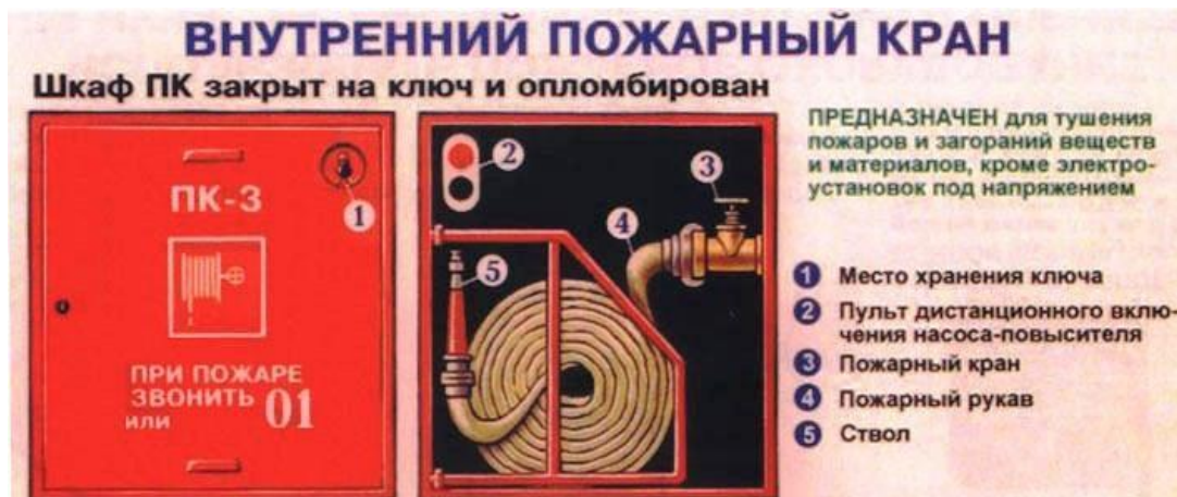
Рисунок 3 – Внутренний пожарный кран
